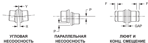
Рис. 6. Центровка соединительных муфт
